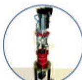
attuatore lineare elettropneumatico con faraday cup raffreddato
